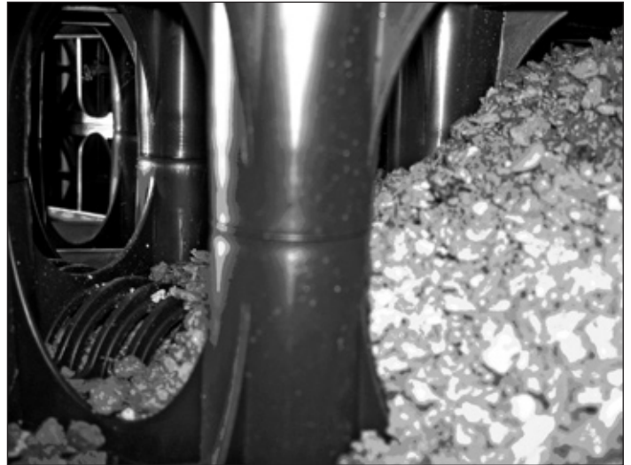
Detailansicht des Kunststoffelements mit Mineralgemisch-Füllung
