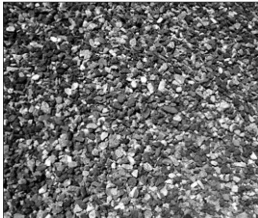
Mineralgemisch aus Natursteinen verschiedener geomorphologischer Entstehungsformen und Herkünfte mit diversen Zusätzen (z.B. Enregis/Bioalith MR 0/8 mm). Fotos: Enregis
